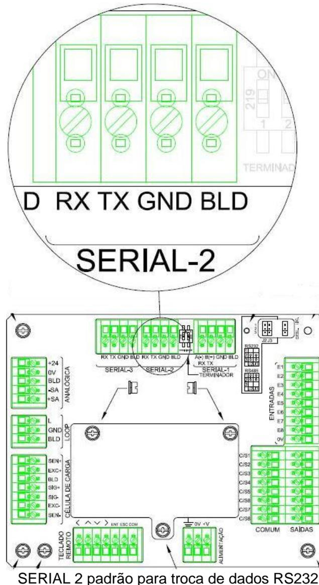
A configuração da porta serial embutida é realizada através da tela 04 rS2.
