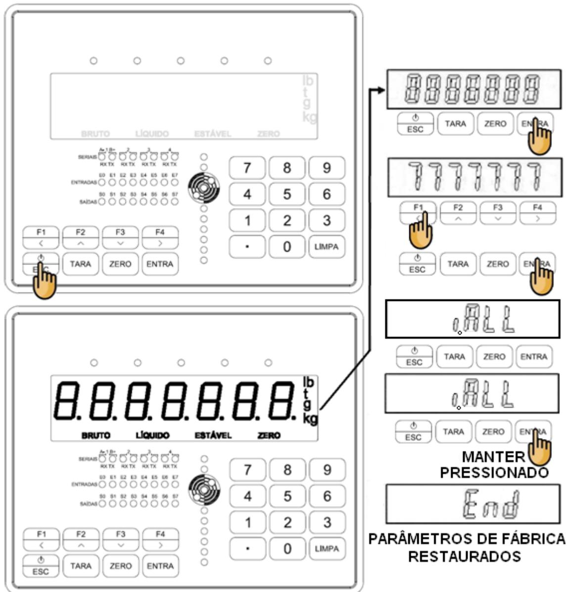
Parâmetros de fábrica recuperados, coloque a chave de calibração na posição LOCK.
