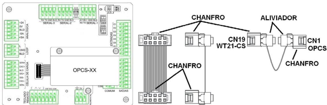
Uma vez conectado o cabo no ponto acima mostrado, a fixação deve ser feita fazendo uso dos 3 parafusos presentes na OPCS-XX utilizada.
