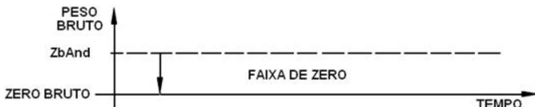
O setpoint ZbAnd utiliza o zero bruto como referência e é utilizado para indicação de que o silo esta com nível baixo, ou seja, a quantidade de material no silo não é mais suficiente para fazer uma dosagem. Existem 2 modos para determinar ZbAnd:
