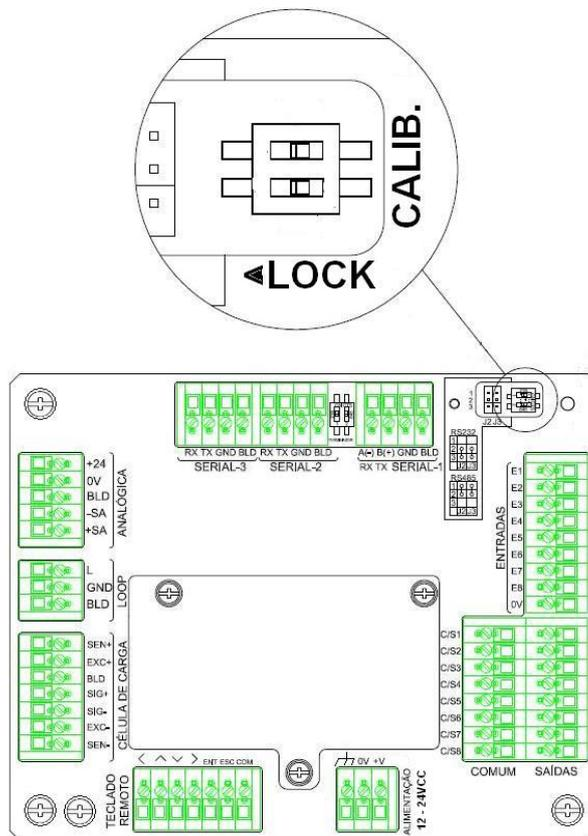
Estando com o jumper de calibração na posição LIG., pressione novamente a tecla ESC para ligar o indicador.
